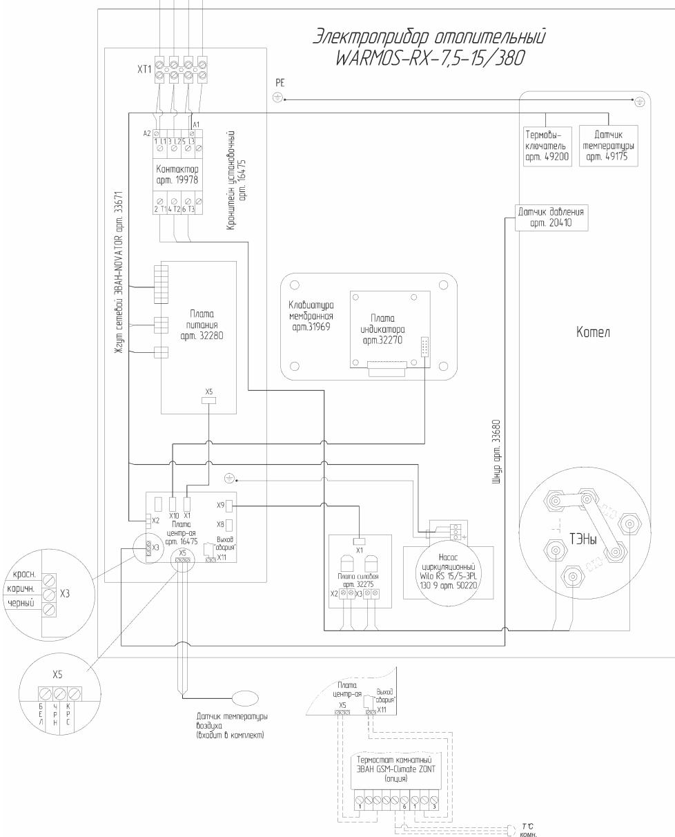
Рисунок 8 Схема подключения WARMOS-RX -7,5-15 (380)
