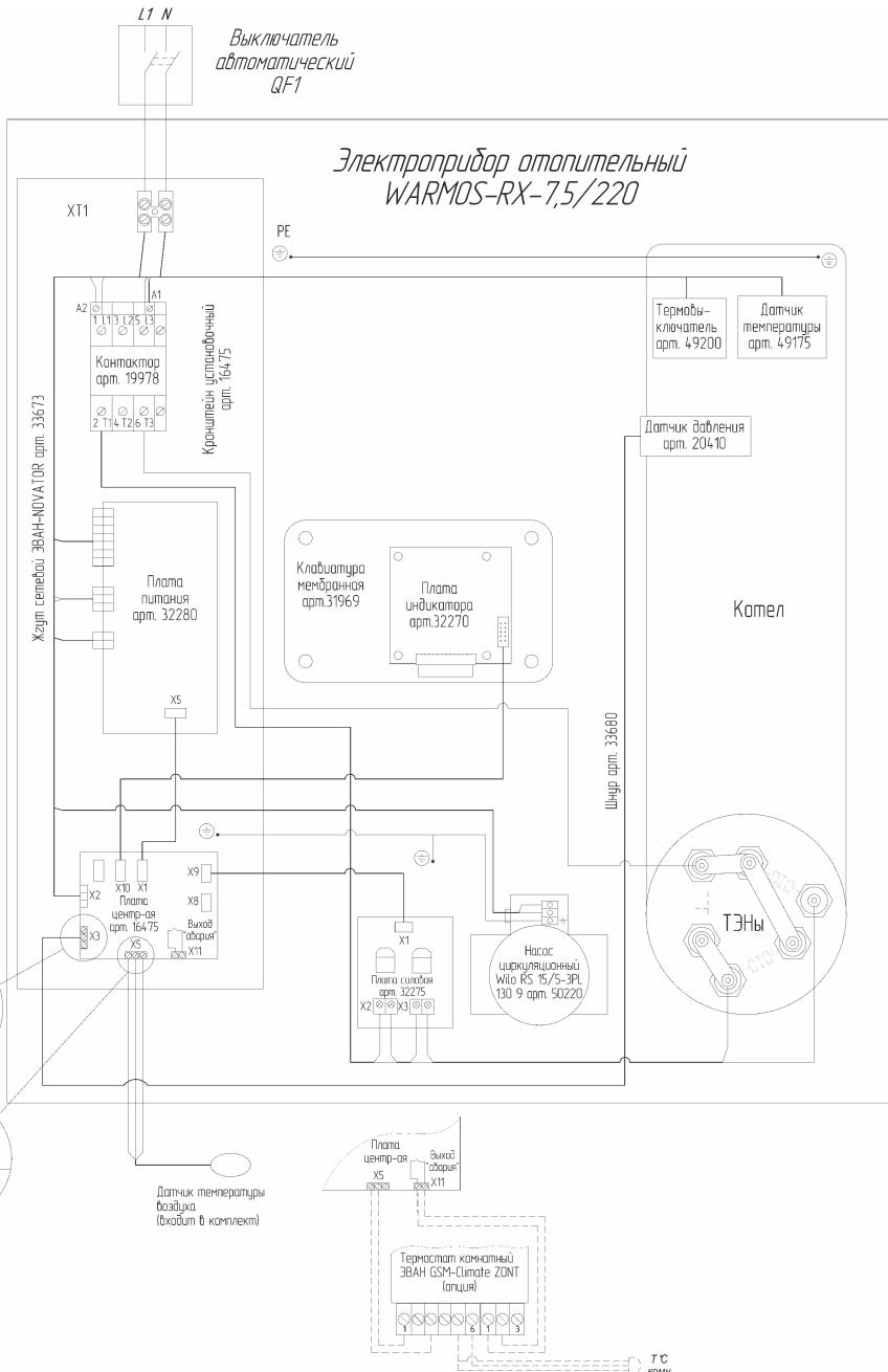
Рисунок7 Схема подключения WARMOS-RX -7,5 (220 В)
