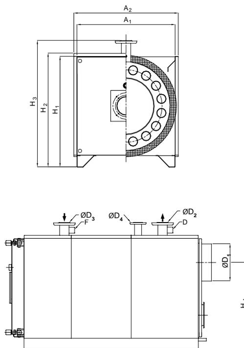
Напольные • Стальные водогрейные жаротрубные котлы с реверсивной камерой сгорания под наддувную горелку • RVS2
