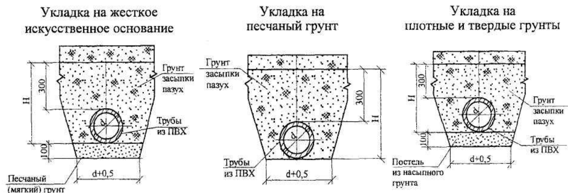
Рис. 4 Схемы укладки труб из ПВХ в грунте
