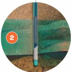
Фильтры для скважин изготавливаются трех видов: Щелевые (для неглубоких скважин полускальных неустойчивых, щебнистых и галечниковых пород); с напылением из ПВД (для всех несупфизионных несвязанных и связанных грунтов с повышенной защитой от механических примесей); со стальной сеткой галунного плетения (для первичной очистки питьевой воды в глубинных скважинах).
