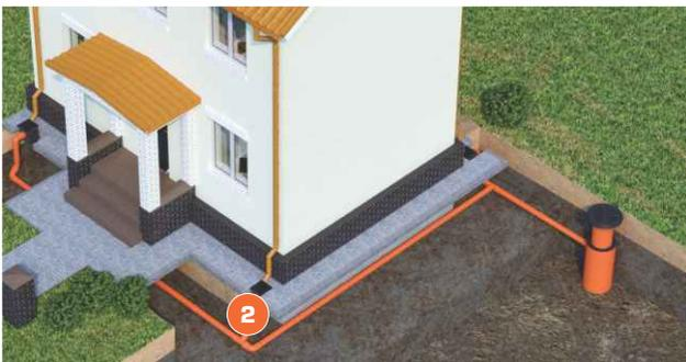
Слив дождевой воды производится в контрольно-ревизионный колодец, откуда по трубам для системы канализации НПВХ попадает в ливневую канализацию.
