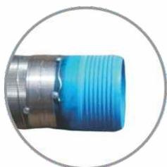
Представляет собой перфорированную обсадную НПВХ трубу с двойной обмоткой нержавеющей проволокой и галунной нержавеющей сеткой п. 56. Такой фильтр применяется для очистки от средне- и мелкозернистых песков (с преобладающим размером частиц 0,1–0,25 мм более 50% по массе), но не рекомендуется применять сетки с галунным плетением на глинистых почвах.
