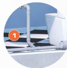
Стояк системы внутренней канализации монтируют из самотечных раструбных труб Ф110мм. Для присоединения к стояку отводных трубопроводов предусматриваются косые тройники и крестовины (за исключением двухплоскостных крестовин). За счет утолщенной стенки трубы для внутренней канализации из НПВХ имеют повышенную шумоизоляцию.
