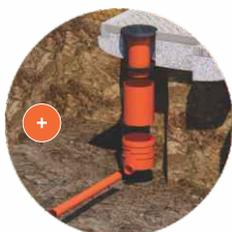
Контрольно-ревизионный колодец предназначен для сбора ливневых вод и передачи их в ливневую канализацию. На колодец надевается пластиковая крышка, которая задерживает попадание в ливневую канализацию посторонних предметов. Сам контрольно-ревизионный колодец собирается из элементов системы наружной канализации НПВХ и состоит из трубы, переходного тройника и заглушки.
