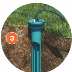
Оголовок для скважины изготовлен из полиэтилена и рассчитан на подвешивание к нему груза до 200 кг. Оголовок имеет резиновое уплотнительное кольцо для его герметизации на обсадной трубе НПВХ, а также карабин для подвешивания насоса, кабельный сальник для герметизации и защиты кабеля, муфту для крепления ПЭ трубы и монтажные петли для удобства работы с оголовком.
