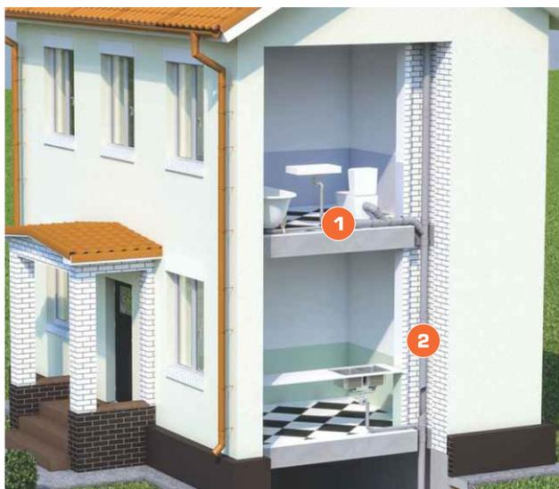
Слив бытовой канализации от умывальника и ванны осуществляется по самотечным раструбным трубам и фитингам Ф50мм, с последующим подсоединением через редуктор к трубопроводу Ф110мм. Уклон для труб Ф50мм должен составлять 3мм на 1 пог.м.трубы. Соединение труб осуществляется через косые тройники.
