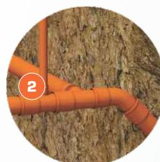
Узел соединения магистральной трубы с трубами с микроотверстиями.
