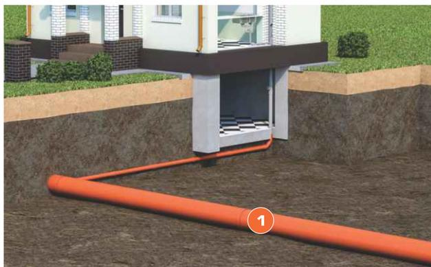
Трубы для наружной канализации применяют в зависимости от объема сточных вод и нагрузок. Для решения данной задачи изготавливаются самотечные раструбные структурированные трубы из НПВХ диаметрами от 110 мм до 500 мм и кольцевой жесткостью Sn2, Sn4, Sn8. Герметичность соединения труб осуществляется за счет резиновых уплотнительных колец.
