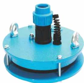
Оголовок для скважины изготовлен из полиэтилена и рассчитан на подвешивание к нему груза до 200кг. Оголовок имеет резиновое уплотнительное кольцо для его герметизации, а также карабин для подвешивания
