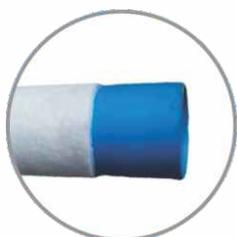
Напыление фильтрующего слоя из ПВД на предварительно перфорированную обсадную трубу НПВХ производится горячим способом. За счет адгезии фильтрующий слой надежно фиксируется на трубе.
