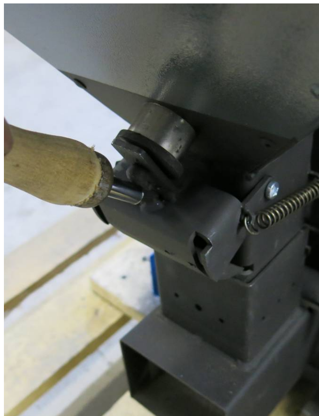
Рис. 27 - Взведение шибера (защита шибера условно не показана, ручка может иметь иной вид)
