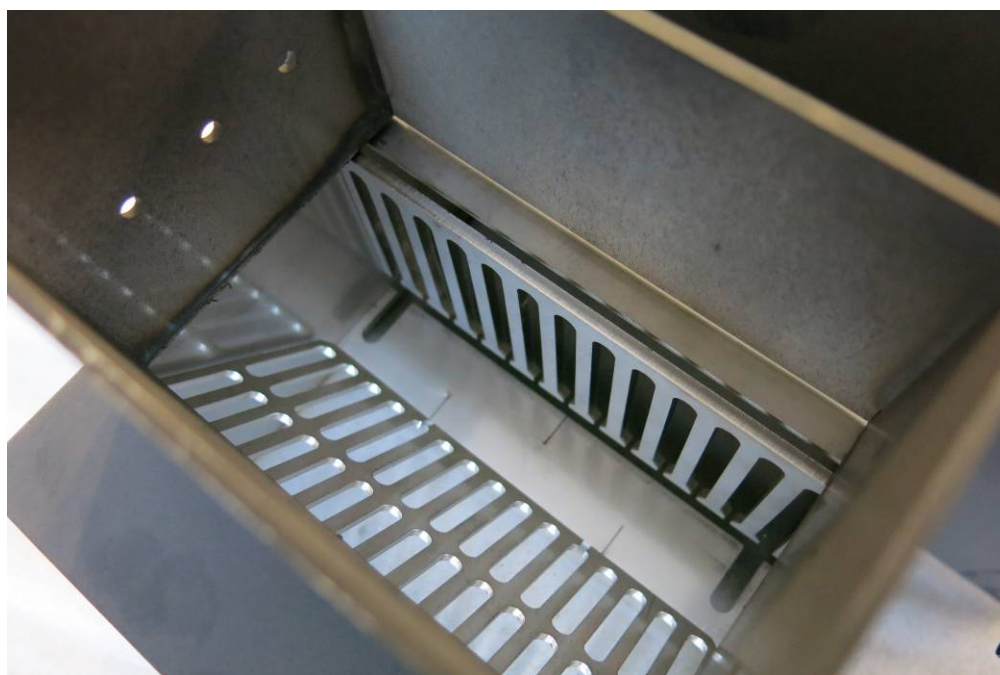
Рис. 21 - Продолжение установка корзины в горелку
