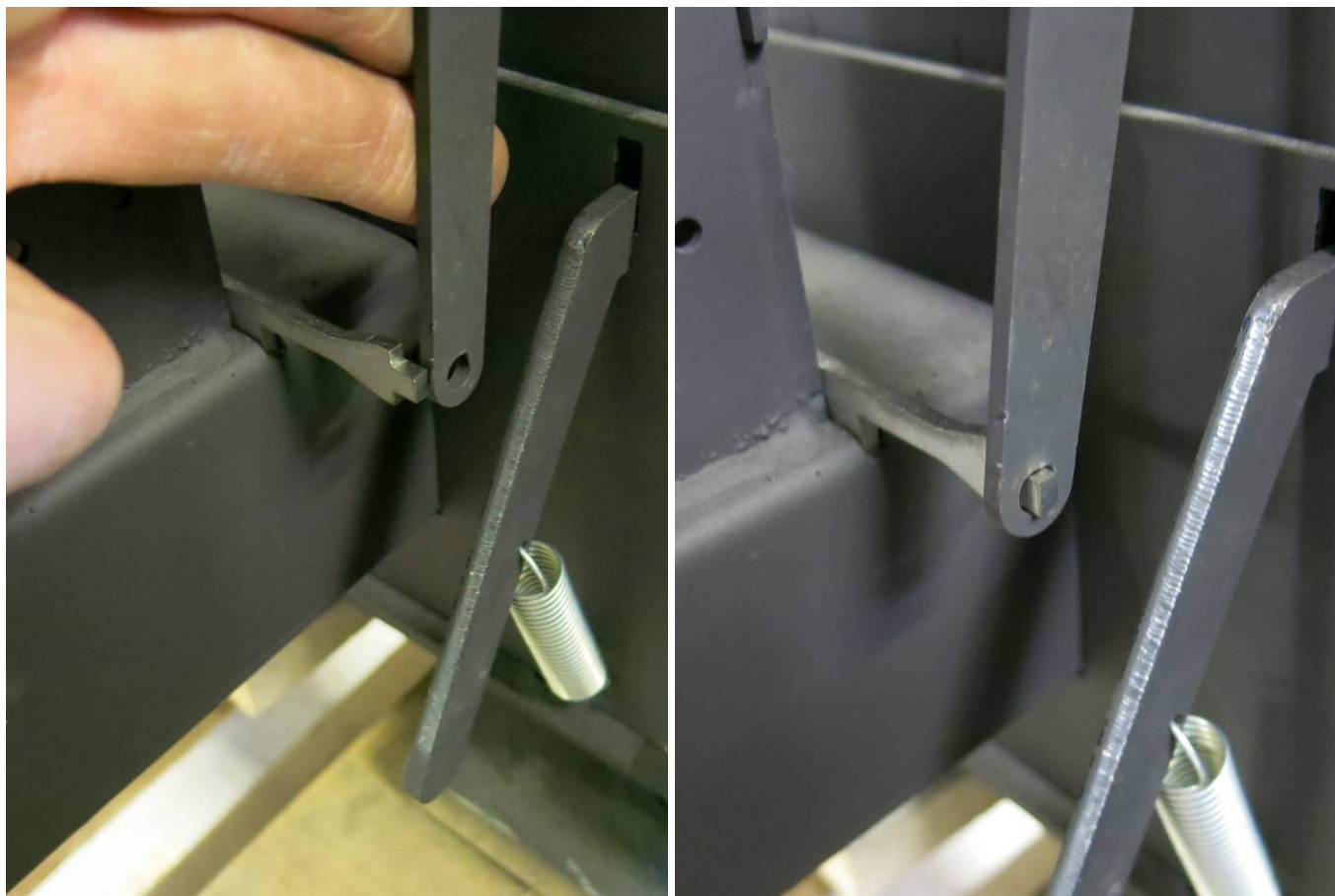
Рис. 25 - Установка тяг регулятора
