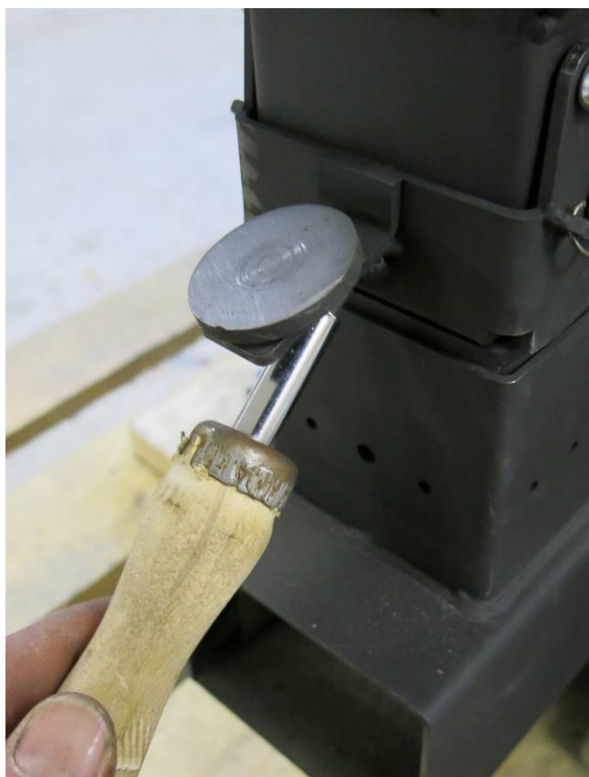
Рис. 27 - Взведение шибера (защита шибера условно не показана, ручка может иметь иной вид)
