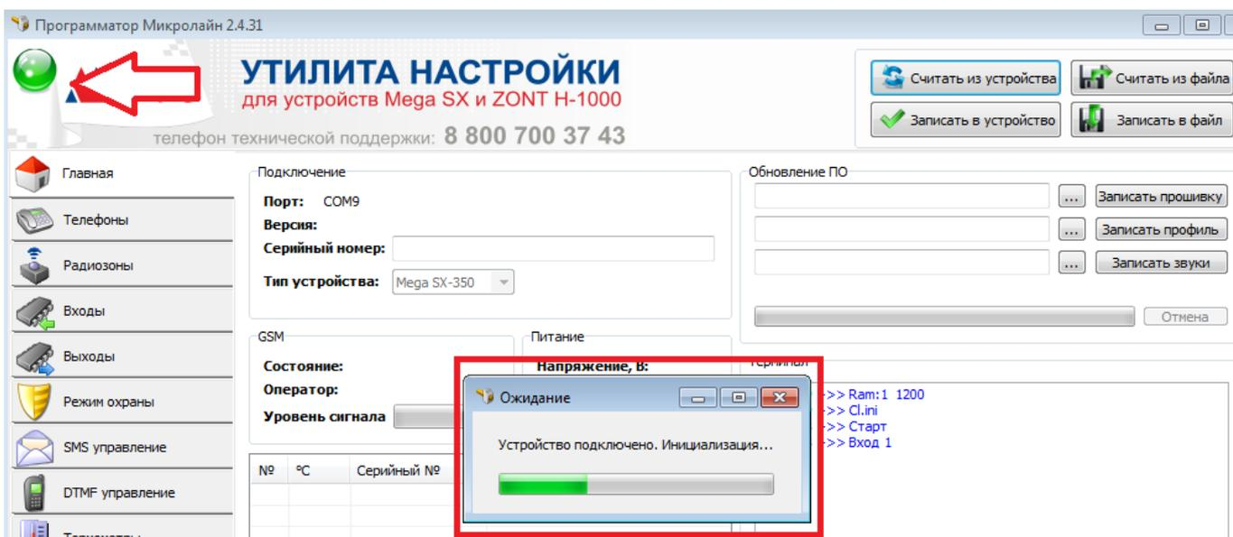
3. Соедините Контроллер с ПК через USB-порт с помощью кабеля из комплекта поставки. Цвет индикатора в левом углу рабочего поля изменится с красного на зеленый и начнется процесс подключения.
