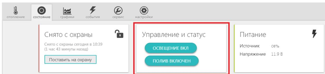
**Команды пользователя** управляют подключенными к контроллеру электрическими приборами и исполнительными механизмами, а **Статусы состояния** - отображают изменение состояния, подключенных датчиков (срабатывание датчиков, во включенном или выключенном состоянии находится прибор, какое действие выполняет управляемый механизм – поливает, греет, освещает и т.п.).
